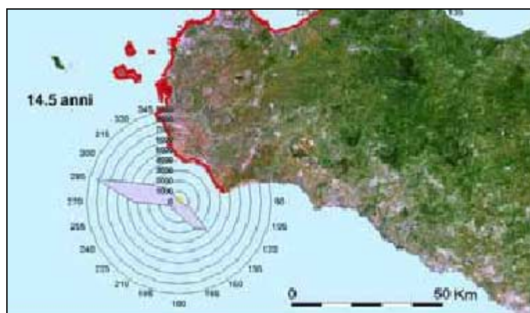
FIGURA 1.3 - RAPPRESENTAZIONE DEL CLIMA DELLE ONDE BASSE REGISTRATO PRESSO LA BOA ONDAMETRICA DI MAZARA DEL VALLO
