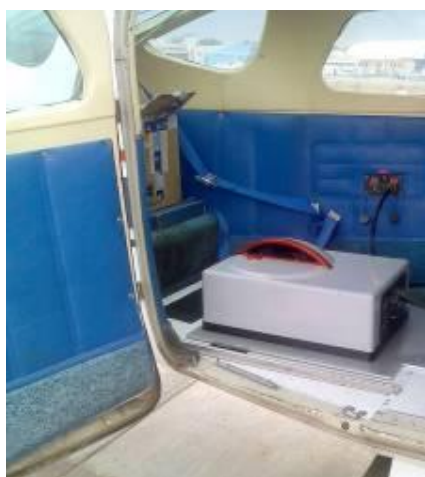
Installazione a bordo dell'aereomobile del sensore LIDAR e del sistema di controllo
