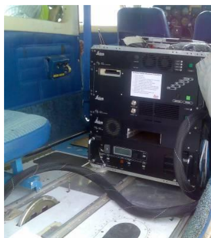
Installazione a bordo dell'aereomobile del sensore LIDAR e del sistema di controllo
