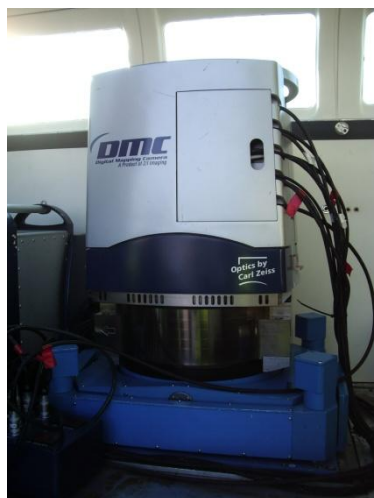
La camera supportata dalla piattaforma
